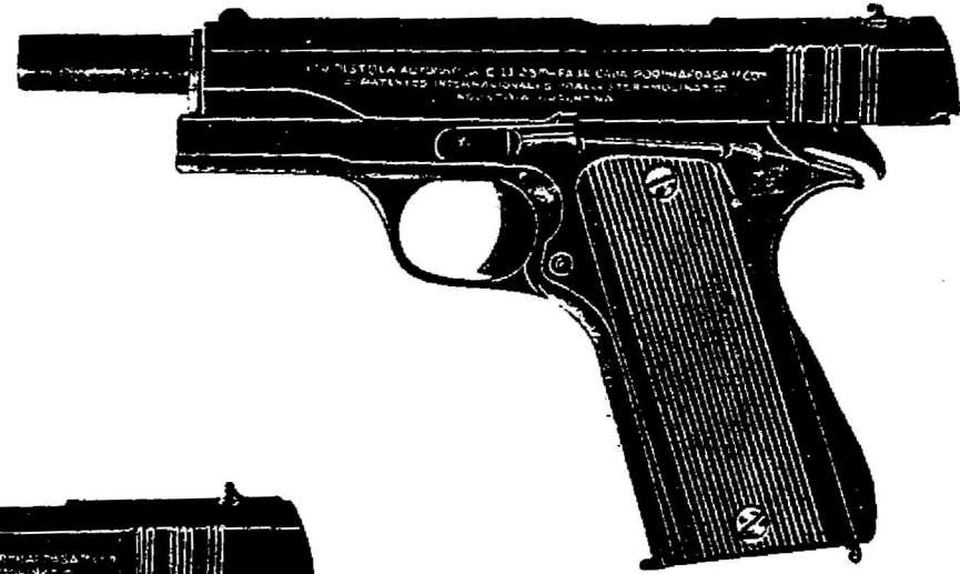
Fig. 7 PISTOLA ABIERTA. — Retén con su talón cabando en la corredera.
